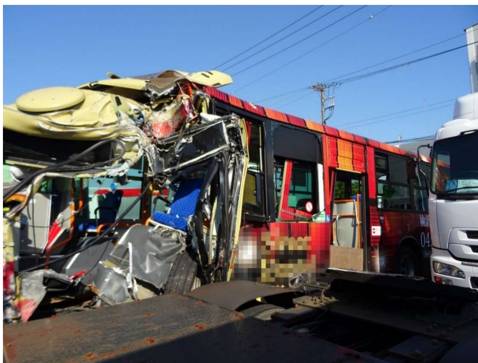
写真5 当該車両の損傷状況（前方）
