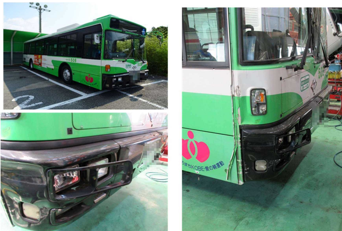
写真3 当該車両損傷状況
